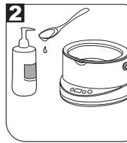
**Усиленная чистка:** Применяется для чистки сильнозагрязненных, замасленных изделий. Погрузите изделия в контейнер или пластиковую корзину (а затем погрузить в контейнер) и наполните водой.
