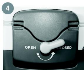
При поворачивании рычага "open-close", находящегося с обратной стороны блока управления по часовой стрелке, откроется паз, в который необходимо вставить ирригационную трубку.
