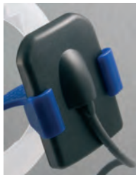
Установите датчик по центру проводом вниз.
