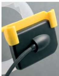
Датчик следует разместить как можно ниже, как показано на рисунке. Верхний край датчика выравнивается по средней линии клевши.
