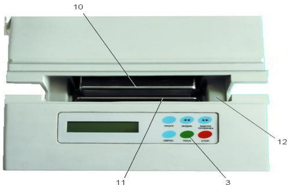
Рис. 4. Вид насосного отсека, панели индикации и управления аппарата
