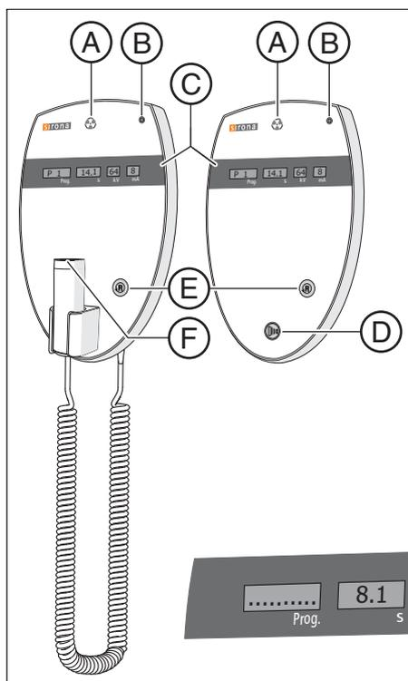
С помощью устройства дистанционного пуска рентгенографию можно начать с помощью пускового устройства **D**. Если при начале рентгенографии визуальный контакт с пациентом невозможен, пусковое устройство со спиральным кабелем **F** можно снять с рентгеновского аппарата и использовать с устройством дистанционного пуска.
