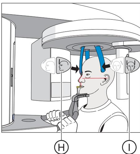
14. Нажмите кнопку регулировки опоры для лба **H** и кнопку височных опор **I**.
