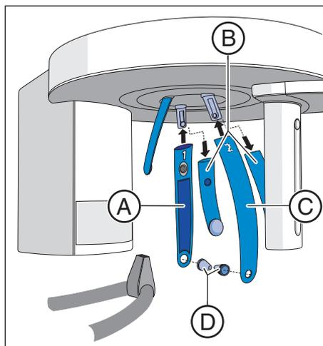
Для рентгенографии ВНЧС опоры для ВНЧС А „1“ справа и С „2“ слева должны быть установлены вместо височных опор В.
