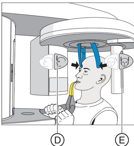
6. Нажмите на кнопку регулировки опоры для лба **D** и кнопку височных опор **E**.
