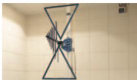
**ОБОРУДОВАНИЕ ДЛЯ ИЗМЕРЕНИЯ ЭЛЕКТРОМАГНИТНЫХ ВОЛН**
