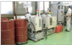
Специальный фильтр позволяет повторно использовать 97% эмульсионного масла.
