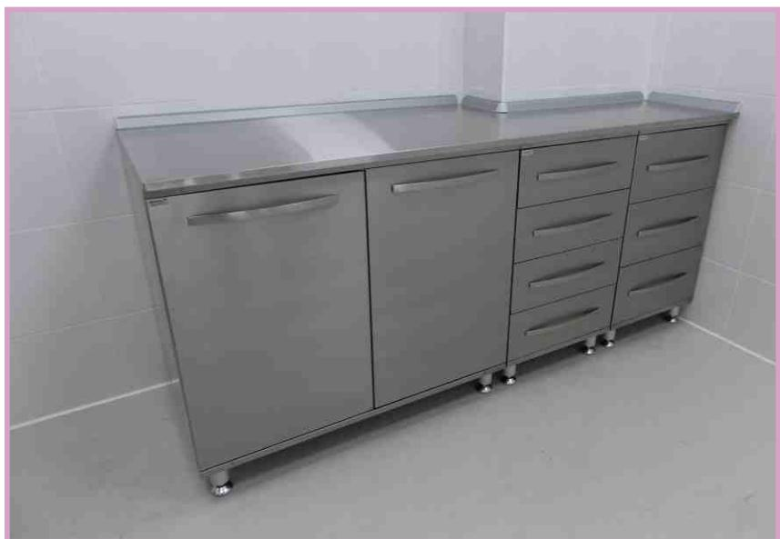
Столешница также изготавливается из нержавеющей стали. Столешница имеет толщину 30мм и оснащается подложкой из постформинга, поэтому столешница не прогибается под большим весом.
