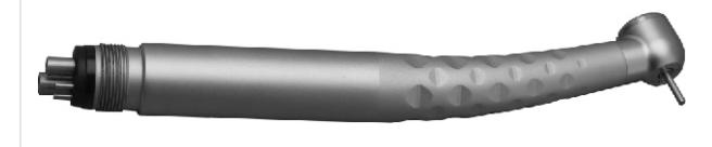
Наконечник турбинный с кнопочной фиксацией бора, с трёхточечным распылителем охлаждающего спрея. Предназначен для закрепления режущих инструментов (боров) 1,59-1,60 мм и приведении их во вращение при выполнении зубоврачебных работ. Область применения - терапевтическая и ортопедическая стоматология.
