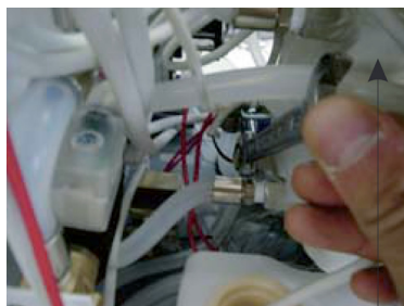
2. Открутите датчик против часовой стрелки ключом на 12
