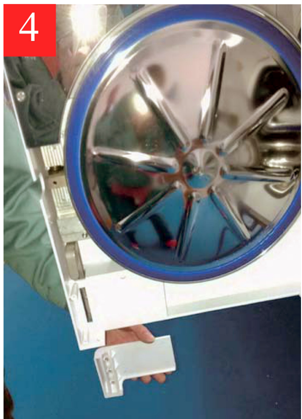
4. Ручку двери можно снять снизу.
