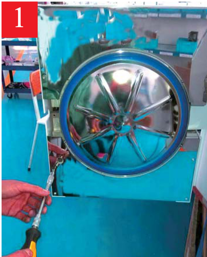
1. Снимите нижнюю часть металлической пластины.
