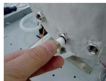
3. Поставьте новый датчик, туго его затяните.
