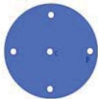
Изображение цилиндра из ПММА для измерения CTDI
