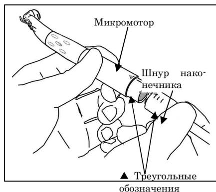
3. Выровняйте треугольные обозначения ( $\blacktriangledown$ ), чтобы подсоединить шнур наконечника к микромотору.
