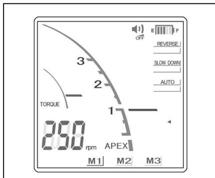
При помощи кнопки выбора режима работы ("Mode") выберите требуемый запрограммированный в памяти аппарата режим работы (M1, M2 или M3) и проводите расширение корневого канала.
