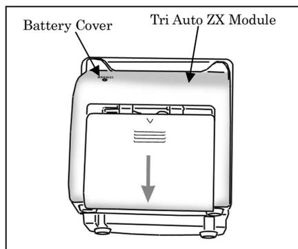
Срок работы батареи составляет приблизительно 1 год в обычных условиях эксплуатации. Батарею необходимо заменить, если она начинает относительно быстро разряжаться после полной зарядки. Используйте только батарею, специально предназначенную для модуля "ДЕНТАПОРТ ЗетИкс Три Авто ЗетИкс".
