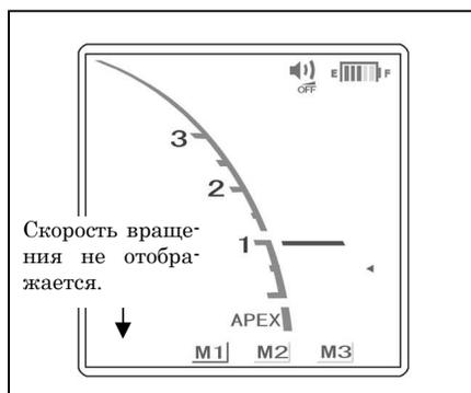
2. Отсоедините шнур наконечника от микромотора. При помощи кнопки выбора режима работы ("Mode") выберите требуемый запрограммированный в памяти аппарата режим работы (M1, M2 или M3) и проводите измерение длины корневого канала. (См. руководство пользователя для модуля "Рут ЗетИкс".)
