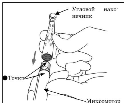
2. Выровняйте точки на микромоторе и угловом наконечнике, после чего установите угловой наконечник на микромотор, пока он надежно не закрепится при помощи простого фиксатора.
