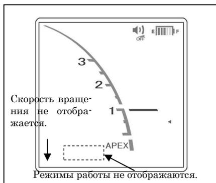
1. При подсоединенном микромоторе нажмите на кнопку выбора режима работы ("Mode"), пока с дисплея не исчезнут обозначения скорости и режима работы. (См. руководство пользователя для модуля "Рут ЗетИкс".)
