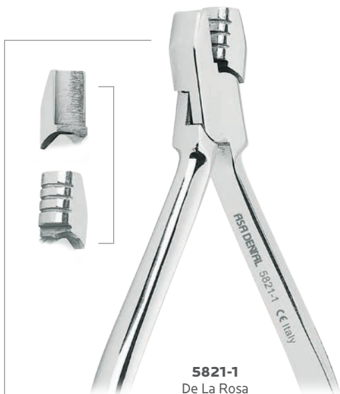
5821-1 De La Rosa Pinza De La Rosa per formare e contornare archi, con guide di 0,4 mm. (.016"), 0,46 mm. (.018") e 0,56 mm. (.022"). Gli archi possono essere in filo tondo o rettangolare De La Rosa arch forming pliers. Designed to form and contour arch wires on round or rectangular wire. The beak has grooves of 0,4 mm. (.016"), 0,46 mm. (.018") and 0,56 mm (.022")
