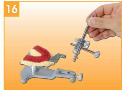
открутите винт и извлеките блок держателя вилки. Release the knob and extract the fork holder block.
