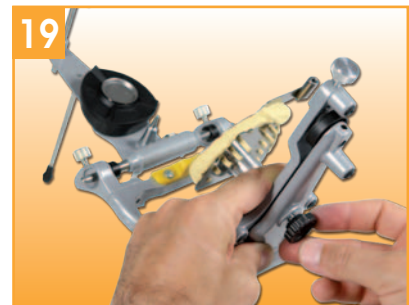
закрепите столик на артикуляторе болтами, идущими в комплекте с артикулятором. Fix the table on the articulator with the screw given with the articulator.
