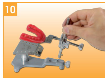
10 Поместите блок держателя вилки на переносной столик... Place the fork holder block into the transfer table...
