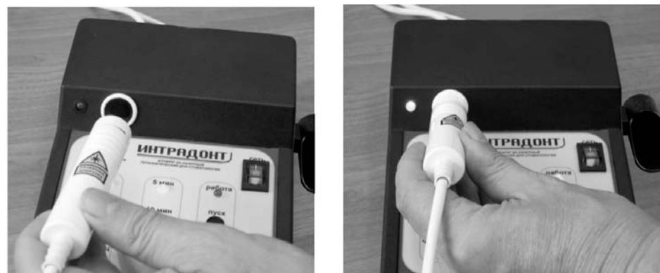
Рис.6. Контроль мощности излучения ИК-лазерного модуля
