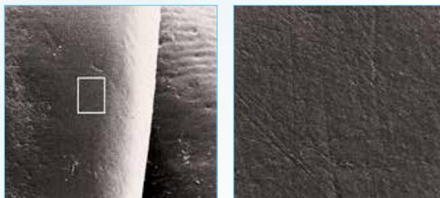
После чистки – изображение, полученное при помощи сканирующего электронного микроскопа (увеличение x20 и x200).
